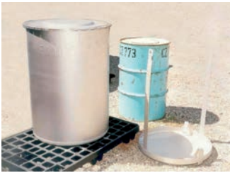
Fût métallique pour enrobés bitumineux et surfût inox EIP
