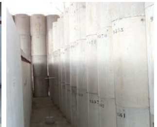
Fûts métalliques temporairement mis en coques en béton pour l'entreposage
