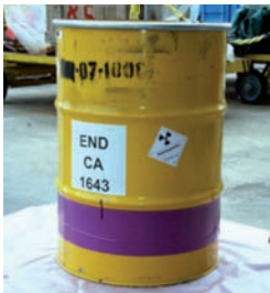
Fûts métalliques de boues et concentrats cimentés
