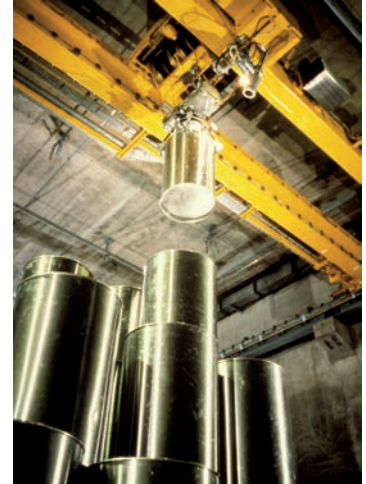
Entrepôt MA-VL de La Hague de colis d'enrobés bitumeux
