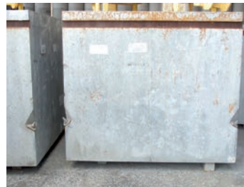
Fûts métalliques temporairement mis en conteneurs en béton pour l'entreposage
