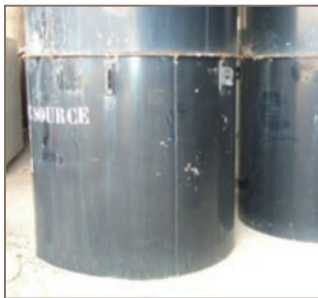
Colis de blocs sources reconditionnés en conteneur en acier puis entreposés à Cadarache
